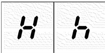
La placa tiene un indicador de superficie caliente para cada elemento. Le muestra qué elementos continúan calientes. El indicador de superficie caliente tiene dos niveles.
