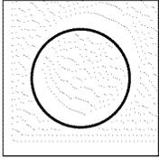
Los elementos individuales tienen sólo una superficie de cocción de un solo tamaño.
