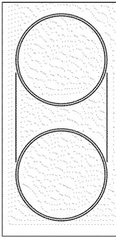
El elemento puente combina dos elementos de calentamiento individuales en un área para asar larga. Esta configuración es ideal para planchas y ollas grandes.
