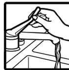
2. Tenir un thermomètre à confiserie ou à viande dans le débit d'eau. Si la température de l'eau au robinet est au-dessous de 49°C (120°F), demander à une personne qualifiée de monter le réglage du thermostat du chauffe-eau.
