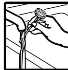
**REMARQUE :** Les charges peuvent ne pas être lavés ou séchés aussi bien si la température de l'eau est trop basse. Pour les meilleurs résultats de lavage de la vaisselle, l'eau doit être au moins à 49°C (120°F) lorsqu'elle pénètre dans le lave-vaisselle.
