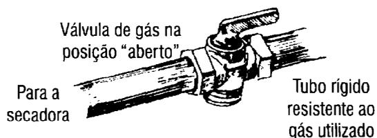
4. Use uma esponja e detergente líquido para testar todas as conexões externas de gás contra vazamentos. Se algum vazamento de gás aparecer, desligue a válvula de gás e reaperte as conexões. Verifique novamente as conexões.
