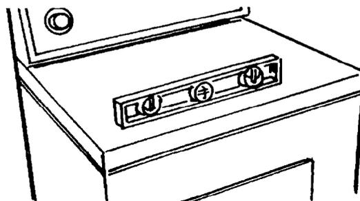
**2.** Verifique o nível da secadora usando um nível. Se a secadora não estiver nivelada, ajuste os pés para cima ou para baixo.
