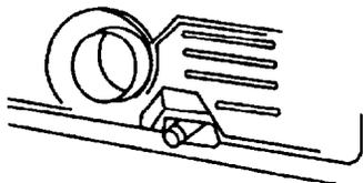
O tubo de exaustão pode ser direcionado para cima, para baixo, para a esquerda, para a direita, ou ainda diretamente para fora pela parte de trás da secadora.
