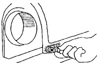
2. Conecte o tubo de suprimento de gás na secadora. Use uma massa para calafetar resistente à ação de G.L.P. nas conexões de gás. Se estiver usando tubulação de metal flexível, assegure-se de que nenhum tubo se dobre.
