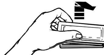
3. Ôter l'ampoule de la douille.
