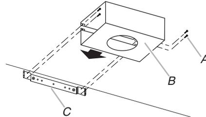
A. Vis d'assemblage
