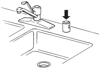
Algunas normas de plomería locales o estatales exigen que se instale una purga de aire del desagüe entre una lavavajillas empotrada y el sistema de desagüe de la casa. Revise la purga de aire del desagüe cuando su lavavajillas no esté desaguando bien.
