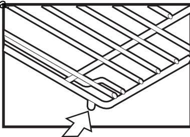
Estos retenedores previenen que la parrilla interfiera con la cubierta del ventilador de convección.
