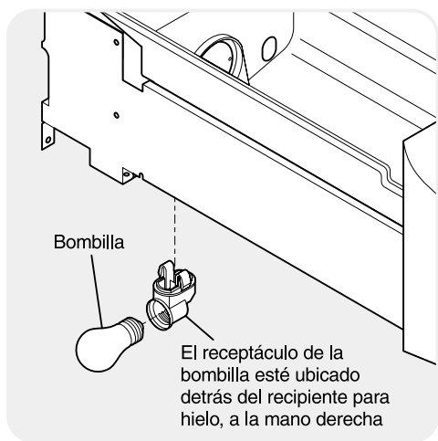
Reemplazo de la bombilla del congelador
